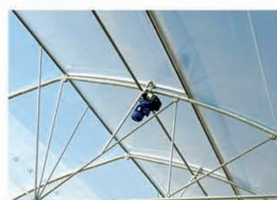
شرکت پارس دشت انواع دریچه های خود را به الکترو موتور های مخصوص که قادریت چرخش ۲/۵ دور در دقیقه و ماکریم طول ۱۲۰ متر دریچه را بازو و بسته می کند مجہز می نماید.
